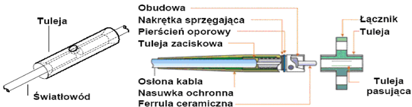
Budowa złączki światłowodowej
